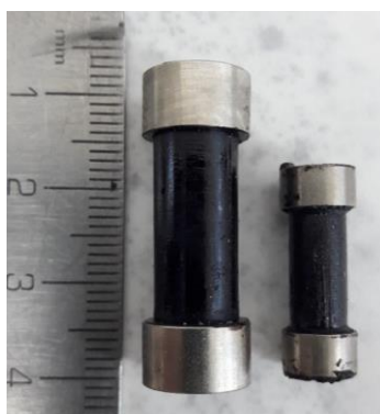
Links: Mastiek proefstukjes. Rechts: Resultaten relaxatieproef op mastiek
